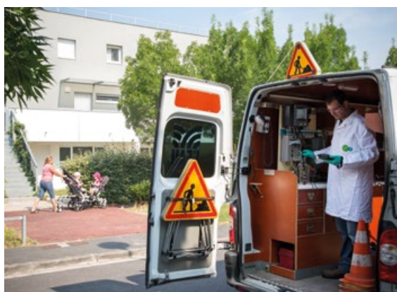
Mobiel laboratorium: de onderzoeker gebruikt een mobiele sensor voor multi-parametrisch analyses van drinkbaar water.
