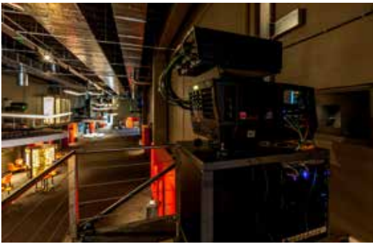
Laserprojectoren laten toe tot 40% energie te besparen ten opzichte van projectoren met xenon-lampen.
