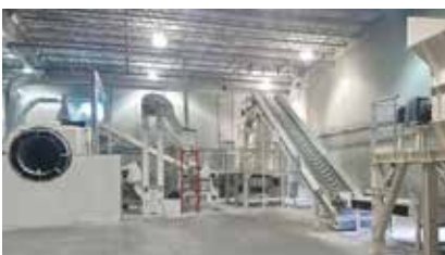
De glasscheider die wordt gebruikt door Shark Solutions, een partner van Safelite, om voorruit te recyclen.
