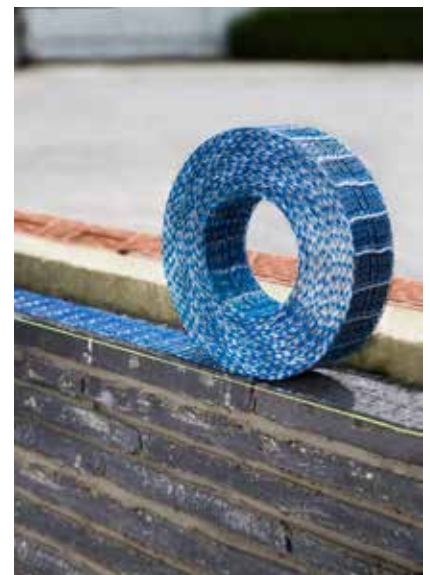
Murfor® Compact, Bekaerts hoogperformante metselwerkbewapening, is een stevig net van staalkoord met hoge treksterkte dat op rol geleverd wordt voor metselwerk met dunne naden en gelijmd metselwerk. De sterke structuur van de bewapening vermijdt barsten en versterkt het metselwerk. Dit lichtgewicht product is gemakkelijk te hanteren en te installeren. Aangezien het ter plaatse op maat kan gesneden worden is er amper verlies.
