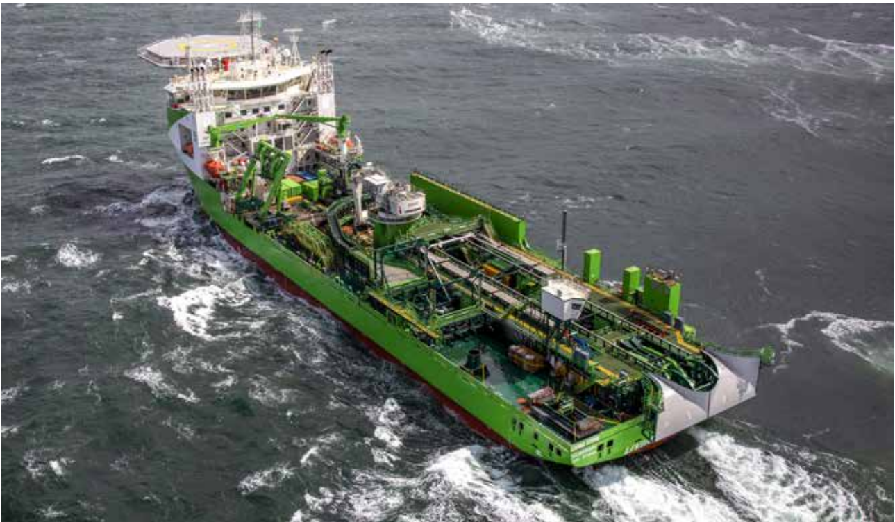
Het kabellegschip 'Living Stone' met twee kabelbanen
