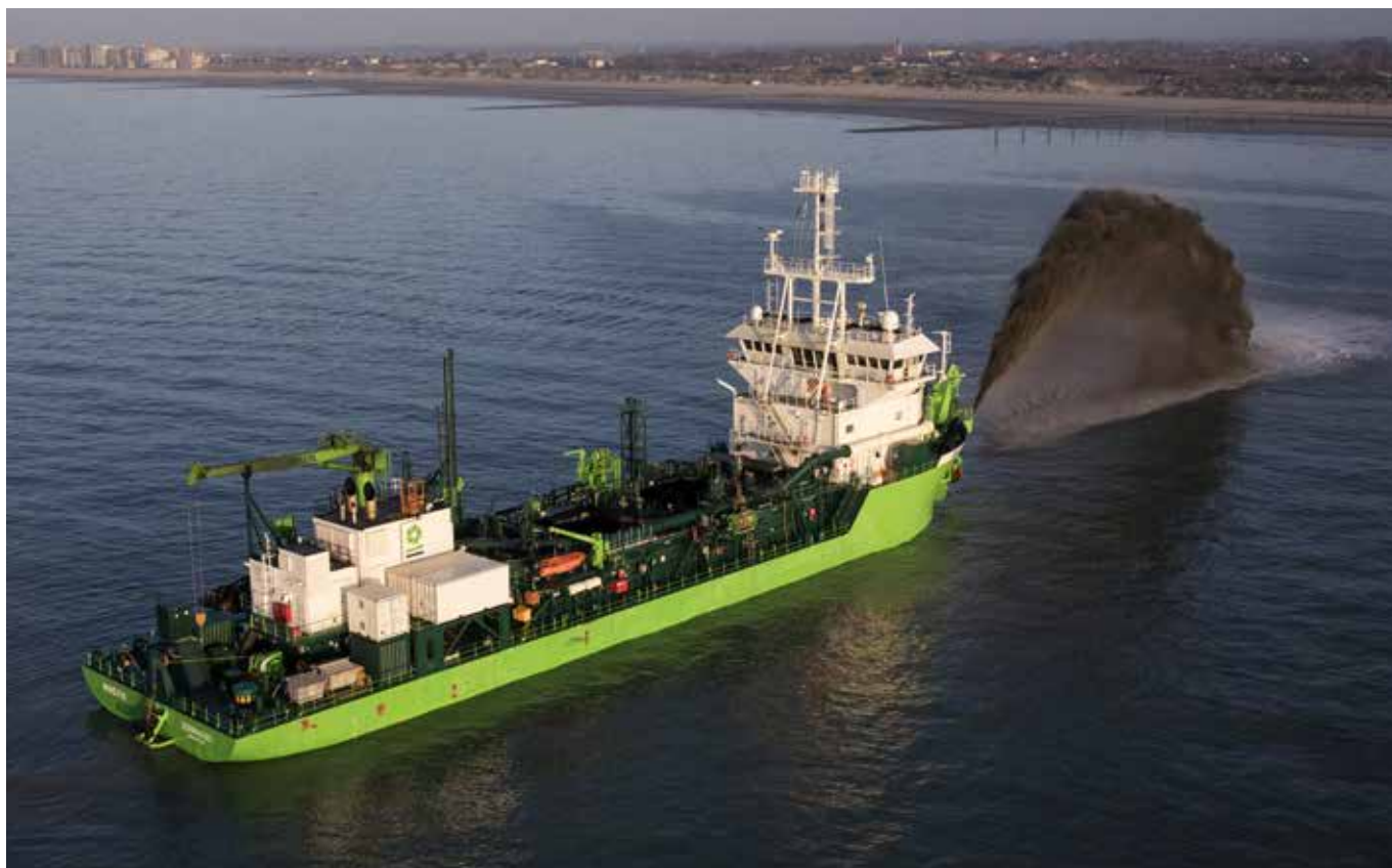
DEME - De Minerva is het eerste baggerschip ter wereld dat op LNG kan werken
