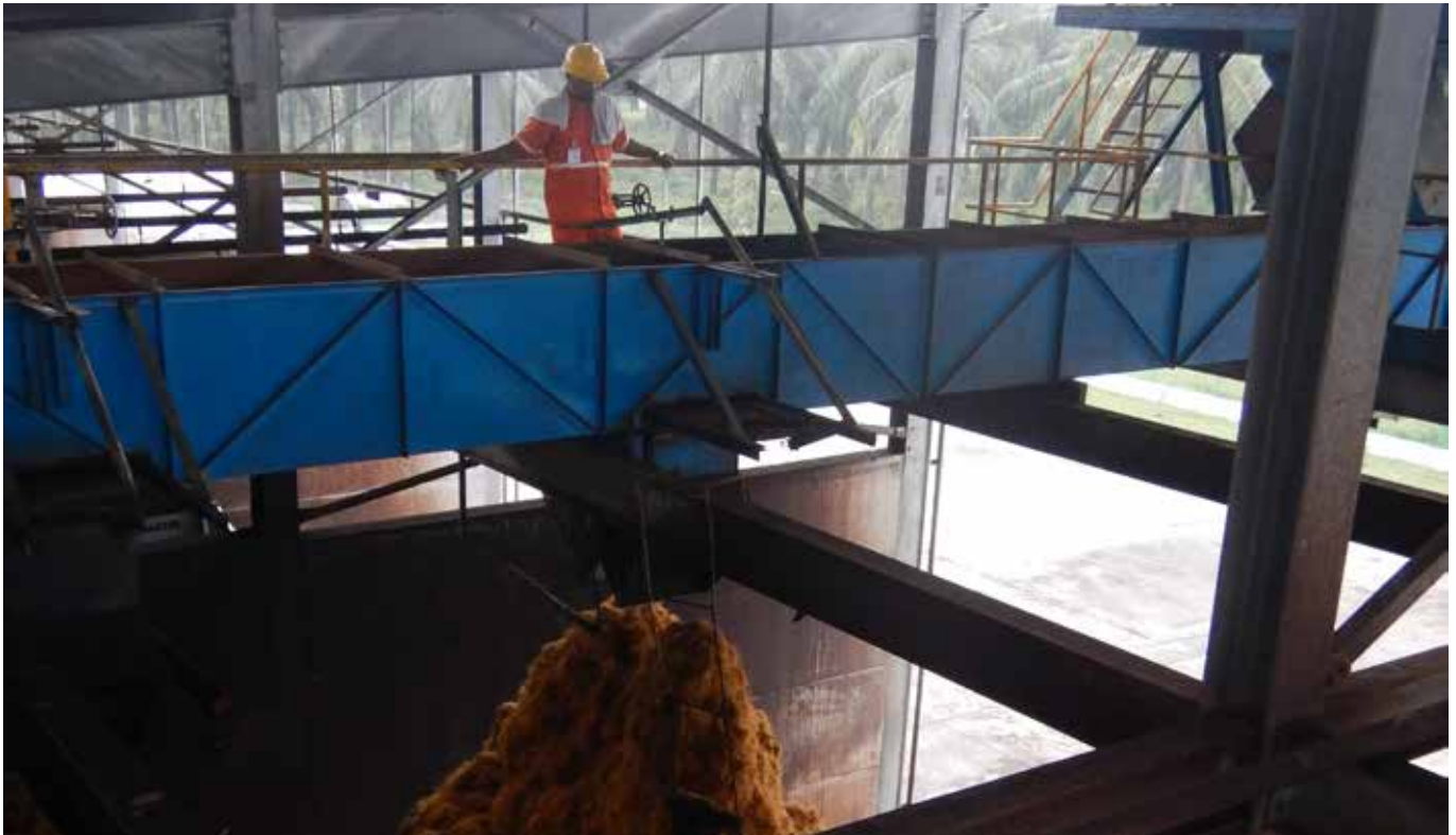
SIPEF - EFB-vezel wordt vermengd met afvalwater in een beluchte composteerbunker (Bukit Maradja)
